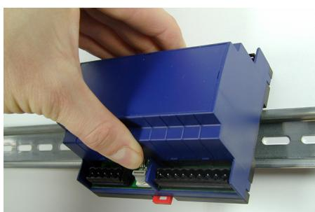
Сначала наденьте верхний направляющий край модуля на шину с профильным наконечником.
