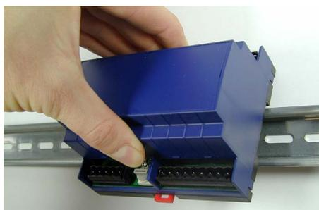
Placer le module de telle sorte que son arête supérieure soit en contact avec le rail de fixation.
