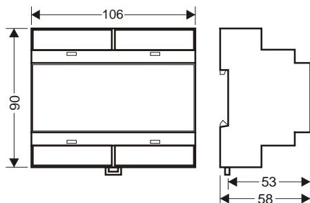
L'appareil est conçu pour un montage sur profilé chapeau. Doté de dimensions normalisées, le boîtier est également adapté au montage dans des tableaux de fusibles, des armoires de distribution ou les blocs d'alimentation des meubles frigorifiques.
