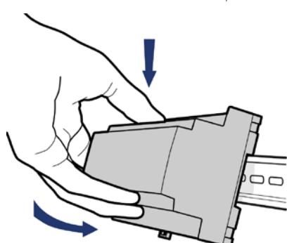
Placer l'appareil de telle sorte que son arête supérieure soit en contact avec le profilé chapeau de fixation.
