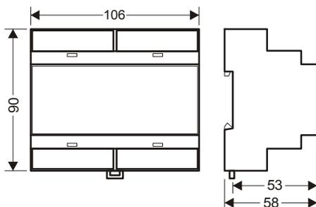
Das Gerät ist für die Hutschiennenmontage vorgesehen. Das Gehäuse hat Normmaße und ist auch für die Montage in Sicherungskästen, Verteilerschaltschränke oder Lastteile von Kühlmöbeln geeignet.
