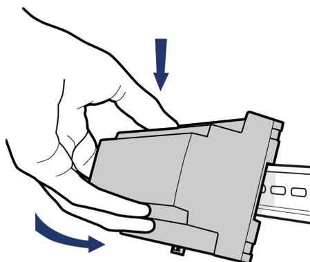
Setzen Sie das Gerät mit der oberen Führungskante auf die Hutschiene.
