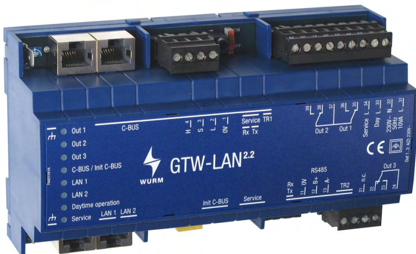
Рис. 1: GTW-LAN 2.2, вид спереди
