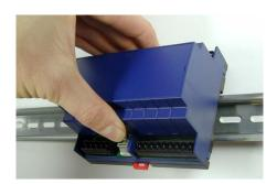
Setzen Sie das Modul mit der oberen Führungskante zunächst an die Hutschiene. Drücken Sie es dann leicht nach unten, bis es mit dem Befestigungsschnapper an der Schiene einrastet.
