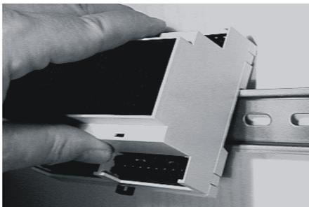
Setzen Sie das Modul mit der oberen Führungskante zunächst an die Hutschiene und drücken Sie es dann leicht nach unten, bis es mit dem Befestigungsschnapper an der Schiene einrastet.
